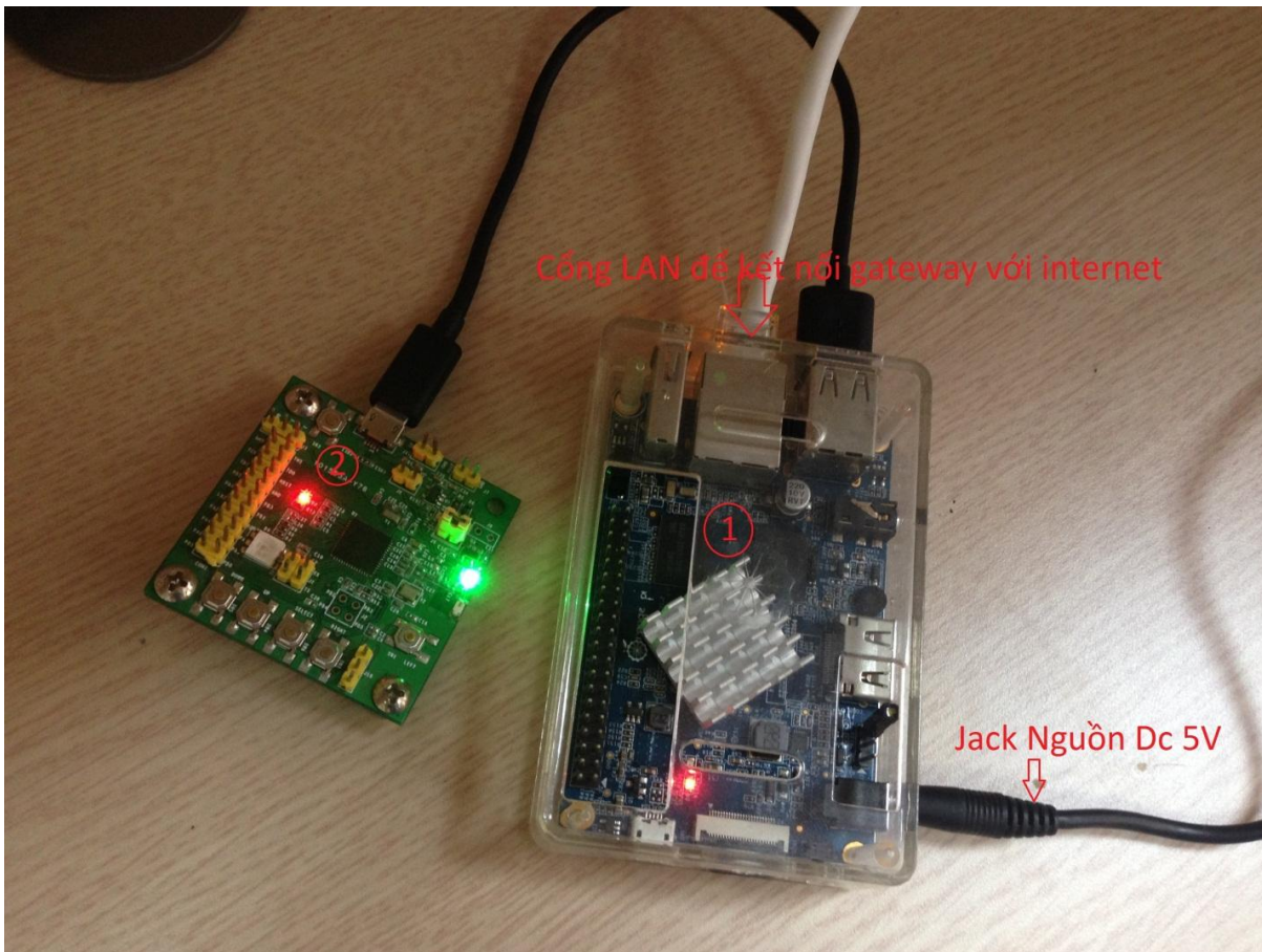
Hình 3.2: Thiết lập thiết bị Gateway
