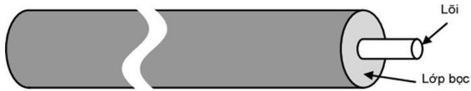
Hình 1.2. Cấu trúc cơ bản của sợi quang
