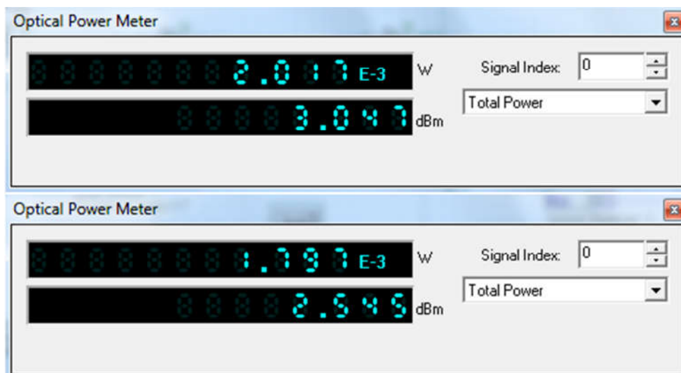
Hình 3.28: Công suất đầu vào và ra hệ thống WDM đa tốc độ
