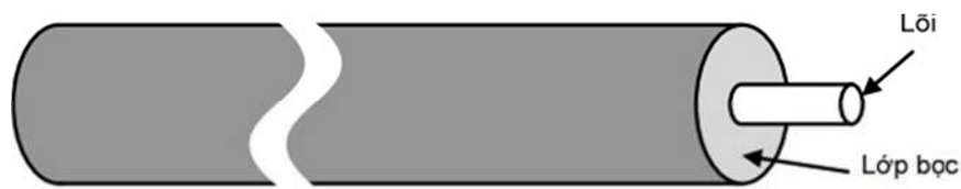
Hình 1.2: Cấu trúc cơ bản của sợi quang
